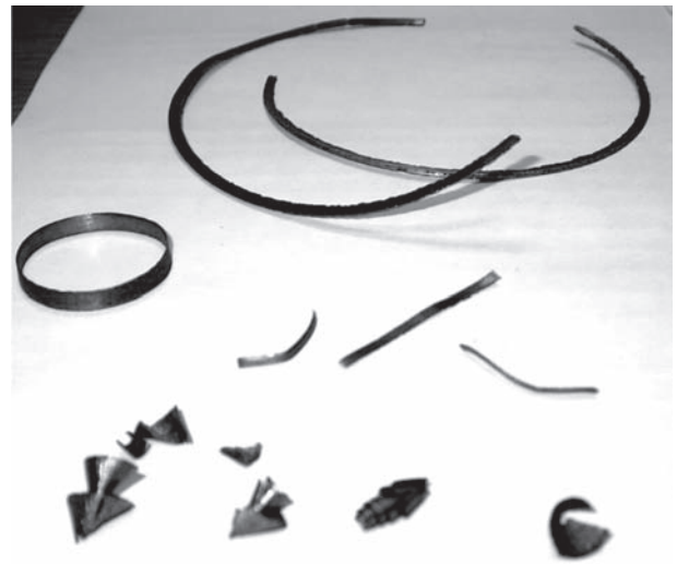
Рисунок 4 — Стружка, образуемая при механической обработке чугуна ВЧТГ
