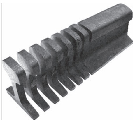
Рисунок 9 — Первый в мире рельс Р65 из высокопрочного чугуна марки ВЧТГ (плавка выполнена 25 сентября 2008 г., рельс разрезан на темплеты для исследований)
